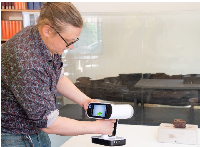
Mike Belasus erfasst mit einem handgehaltenen Streifenlichtscanner Überreste eines alten Bootes.
